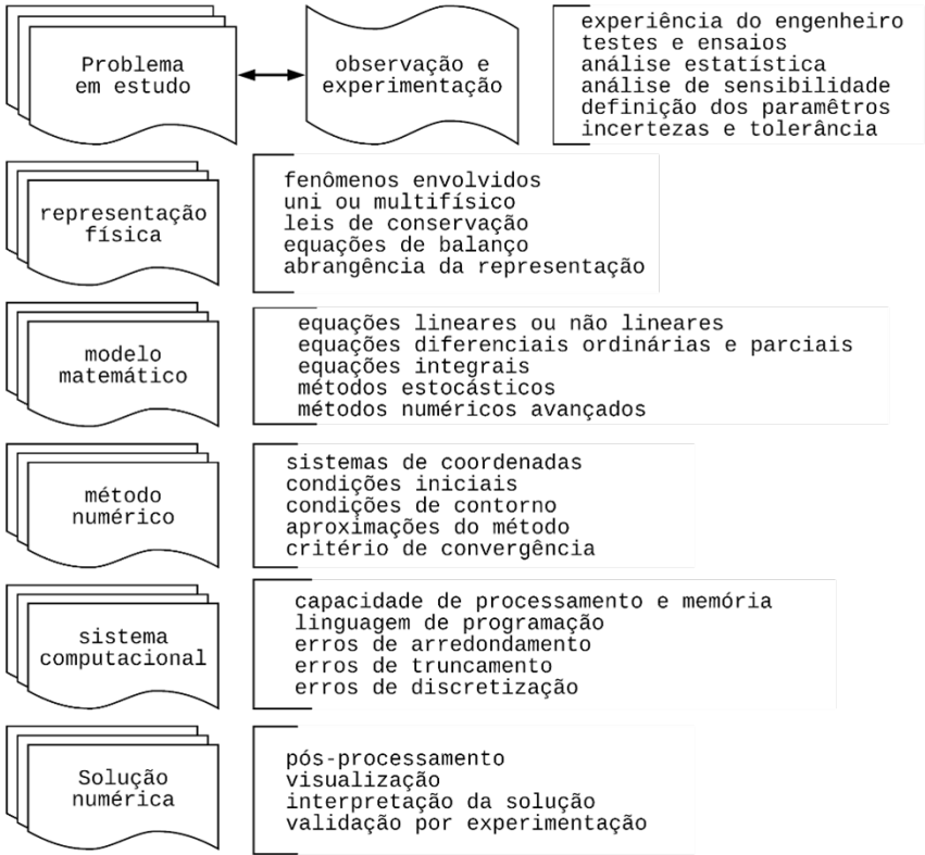
Figura 2.1: Metodologia de modelagem numérica – processo iterativo.
