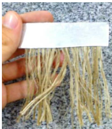
FIGURA 4 – Amostra Submetida ao Ensaio de Absorção de Água
