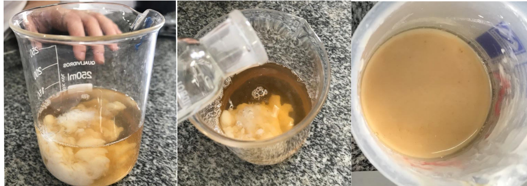
Figura 8 - Solidificação instantânea e formação do gel de síntese.
