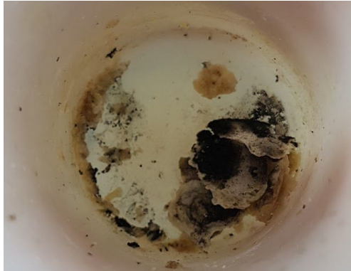
Figura 12 - Resquícios da amostra com o gel de síntese a partir do dióxido de silício
