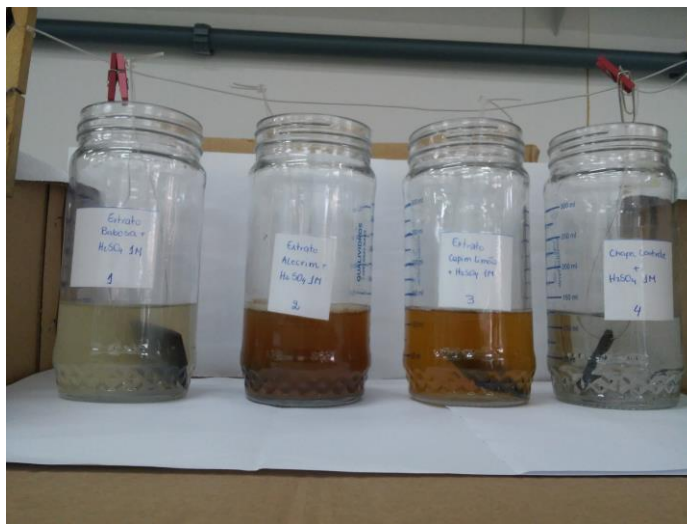
Figura 5: Chapas expostas ao ácido sulfúrico e aos extratos das plantas.
