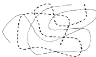
Figura 2. Conformação em novelo de cadeias poliméricas. Fonte: CANEVAROLO JR., 2006, p. 42.
