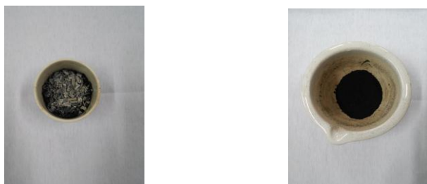
Figura 5: (a) Bainha foliar após a pirólise e (b) aspecto do material após a maceração.
