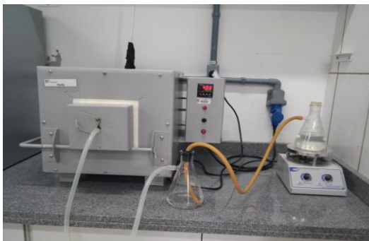
Figura 4: Sistema para produção de N 2 e inserção do mesmo na câmara do forno mufla.
