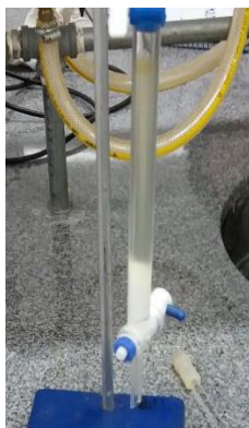
Figura 7. coluna de cromatografia líquida clássica com fase estacionária sílica e fase móvel clorofórmio.
