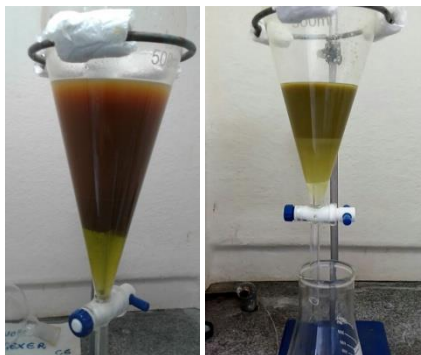
Figura 10. Emulsão formada durante a extração líquido-líquido de um extrato de erva-mate utilizando clorofórmio.
