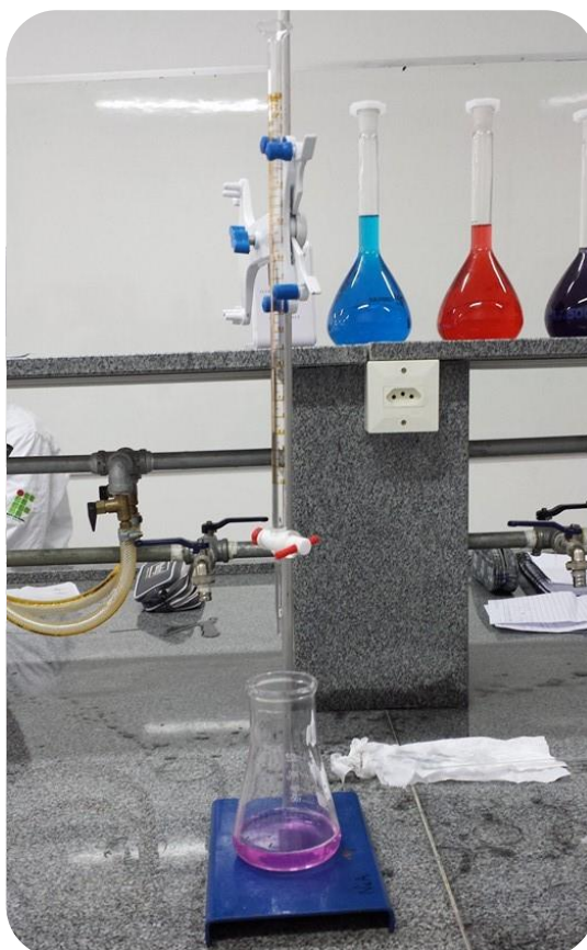
Figura 6: Sistema de titulação montado pelo grupo
