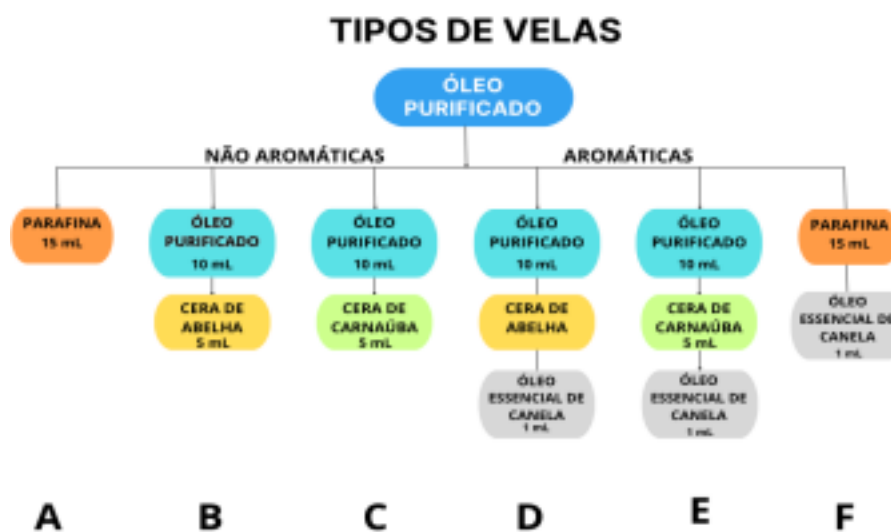
Fluxograma 2: Fluxograma dos tipos de velas produzidas
