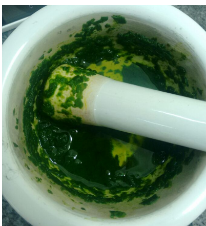
Figura 13: Maceração de espinafre para a extração clorofila utilizando hexano.
