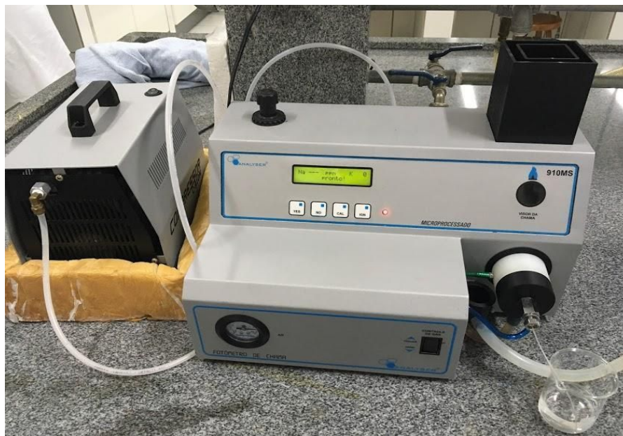
Figura 10: Fotômetro de chama ANALYSER (910MS) do IFSC Campus Jaraguá do Sul - Centro. Fonte: Arquivo pessoal
