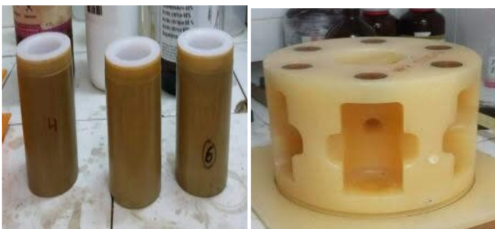
Figura 8. Vasos, proteção dos vasos (denominado de camisas) e suporte para os vasos do forno digestor assistida com radiação micro-ondas (MICROWAVE TYPE MLS 1200 MEGA).
