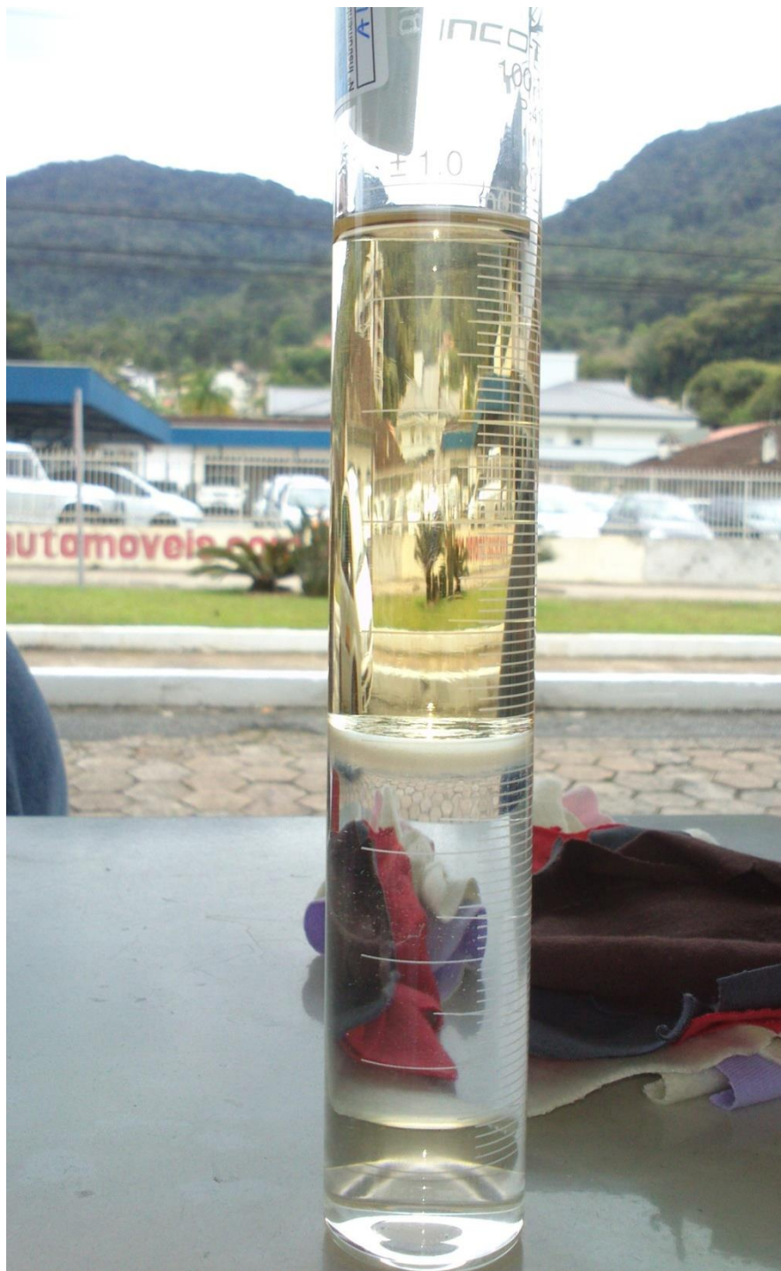
Figura 1: Teste da proveta realizado em um dos postos de gasolina.
