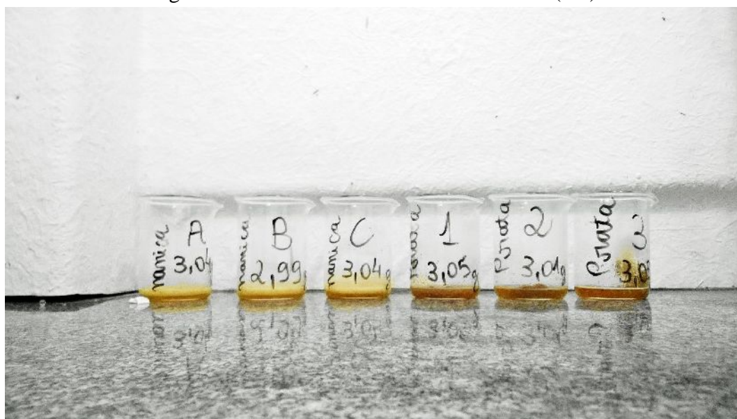
Figura 8: Béqueres com as amostras das duas espécies de bananas no interior da capela, digerindo em ácido nítrico concentrado 68% (PA)
