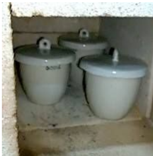
Figura 5: Cadinhos de porcelana com as amostras de banana no interior do forno Mufla
