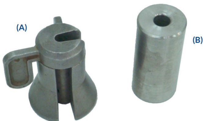
Figura 6: Mensageiro: (A) Equipamento industrializado; (B) Mensageiro manufaturado
