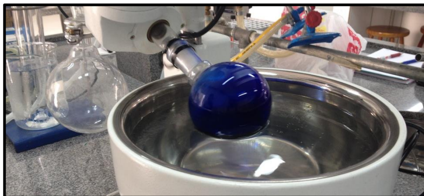
Figura 8: Evaporador rotativo concentrando a cor azul do marcador para retroprojektor.
