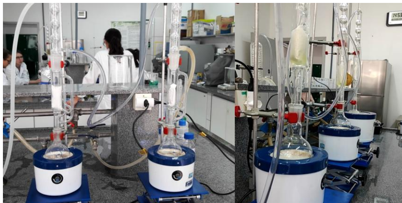
Figura 5. Sistemas de Soxhlet utilizados para a extração de lipídios das amostras de chocolate. Fonte: Acervo pessoal.
