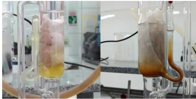
Figura 7. Diferença entre uma extração sem problemas (esquerda) e uma com problemas (direita). Fonte: Acervo pessoal.
