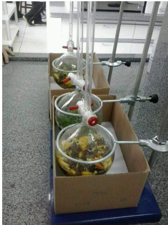
Figura 7 Biodigestor montado em laboratório a partir de peras de decantação invertidas.
