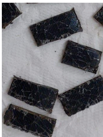
Figura 4: Amostras cortadas com esmerilhadeira.
