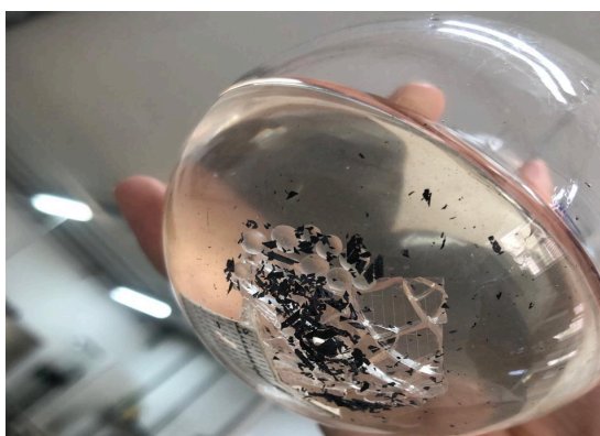
Figura 6: Amostra dos metais separados ao final de uma hidrólise de NaOH de 2 M em 4 horas
