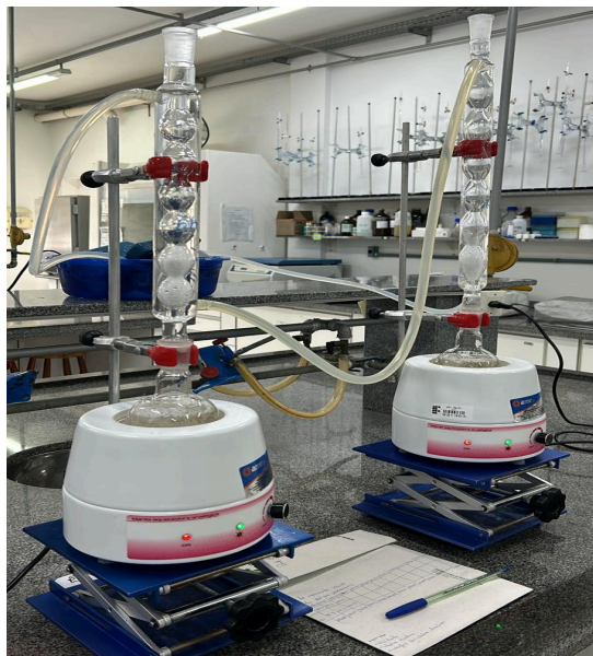
Figura 1 -Sistema de refluxo montado no laboratório do IFSC.
