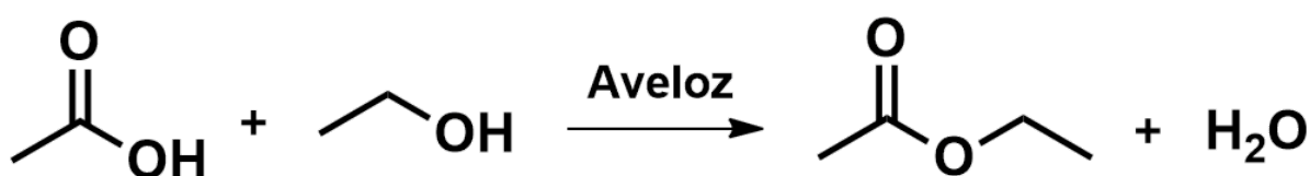
Figura 9. Esquema geral de uma reação de esterificação enzimática do acetato de etila. Fonte: Elaborada pelo grupo.
