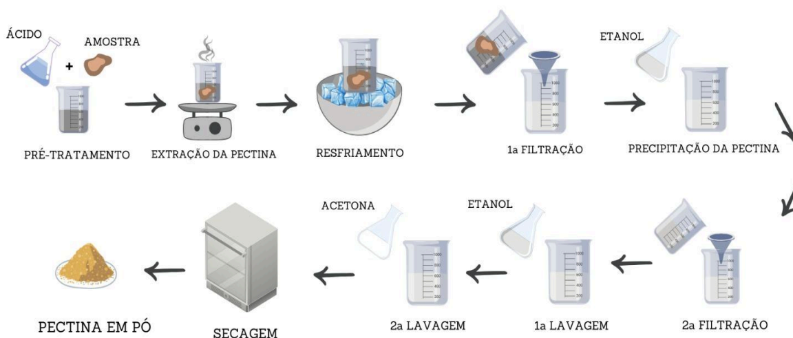
Figura 4: Processo de extração de pectina utilizando o método químico
