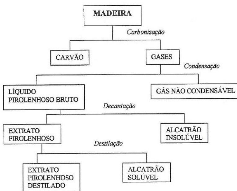
Figura 1: Esquema do Processo de Obtenção do Extrato Pirolenhoso Destilado
