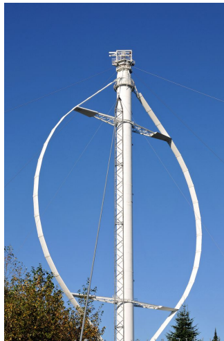
Figura 11: Gerador eólico de eixo vertical.
