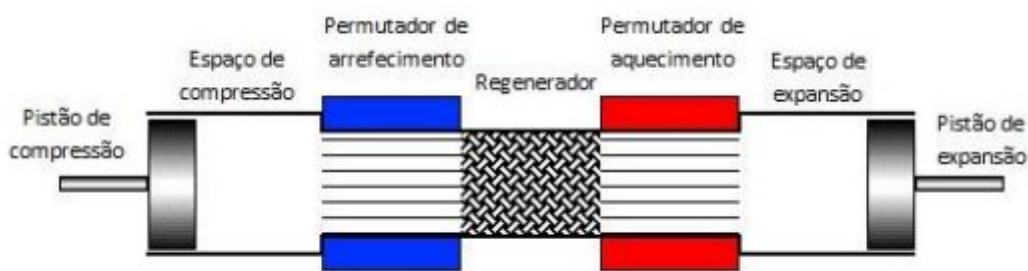
Figura 07: Motor Stirling Alfa.
