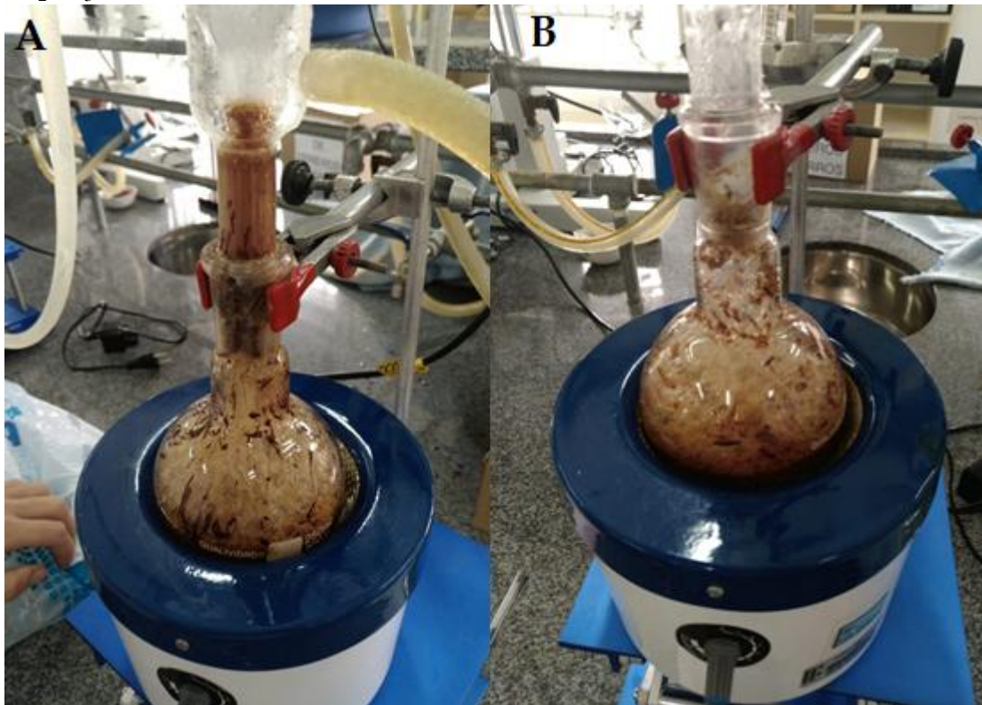
Figura 5: Extração sob refluxo: a) Extração com NaOH como solvente; b) Extração com Na 2 SO 3 como solvente.
