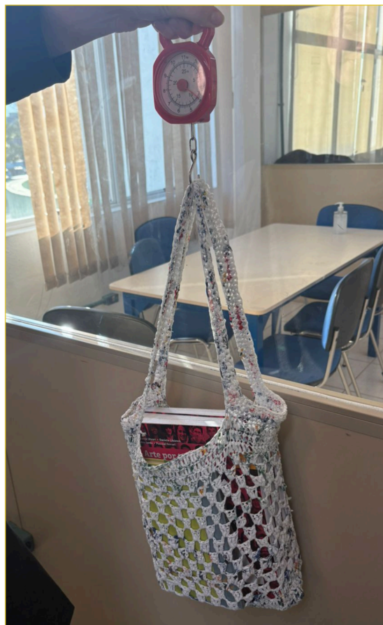
Figura 4: Bolsa 1 modelo “ Ecobag ” durante o teste de resistência descrito
