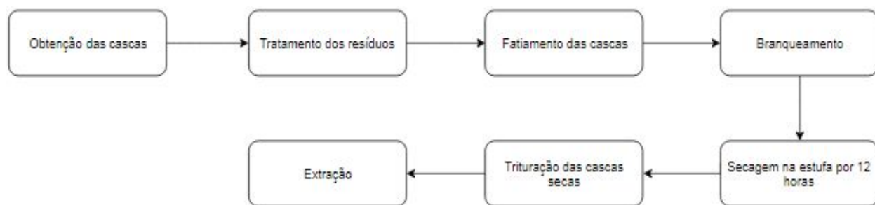
Figura 3: Etapas de tratamento prévio das cascas de maracujá para extração de pectina.
